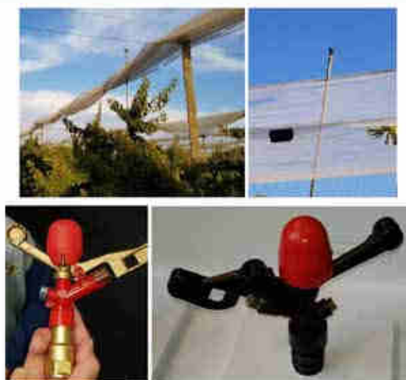
Figura 12. Instal·lació de reg per aspersió en presseguers (dalt). Models d'aspensor específics per a aspersió antigelada en material plàstic (esquerra) i metàl·lic (dreta).
