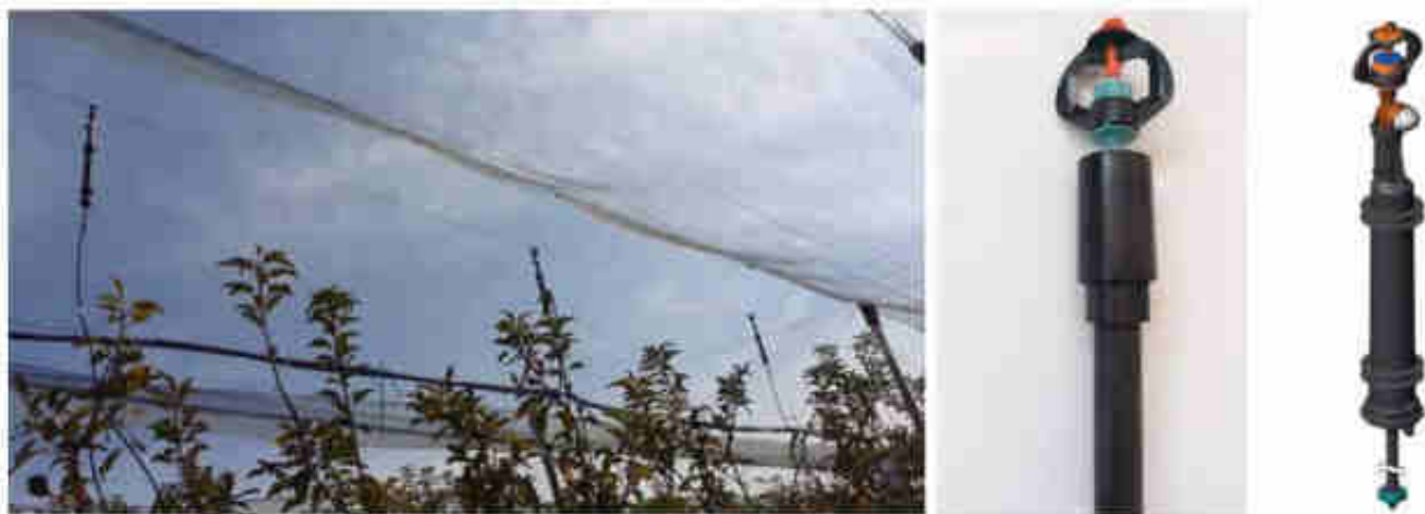
Figura 13. Instal·lació d'un sistema de microaspersió polsant. Esquerra. Dreta dos models de microaspersors amb sistema polsant.
