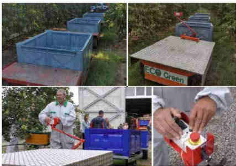
Figura 2. Sistema de trenet remolcat per tractor per la recol·lecció de fruita (a dalt esquerra) i minitractor elèctric per al remolc de palots (a dalt dreta i a baix).
