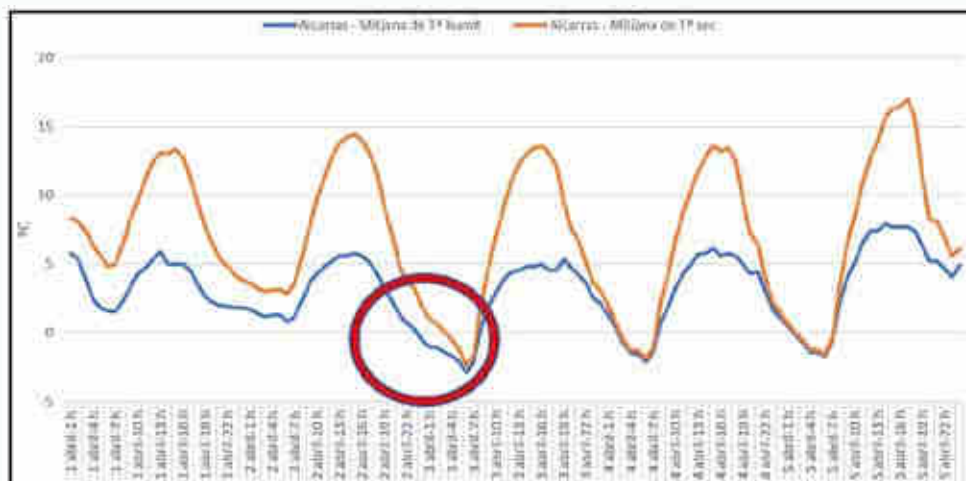
Figura 2. Evolució de la t^a del termòmetre sec i de la t^a del termòmetre humit de l'1 al 5 d'abril a Alcarràs.
