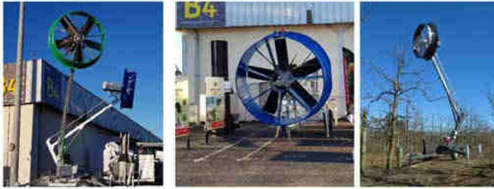
Figura 8. Diversos sistemes de ventiladors mòbils. Tour anti-gel (esquerra i centre). Tow and blow (dreta)
