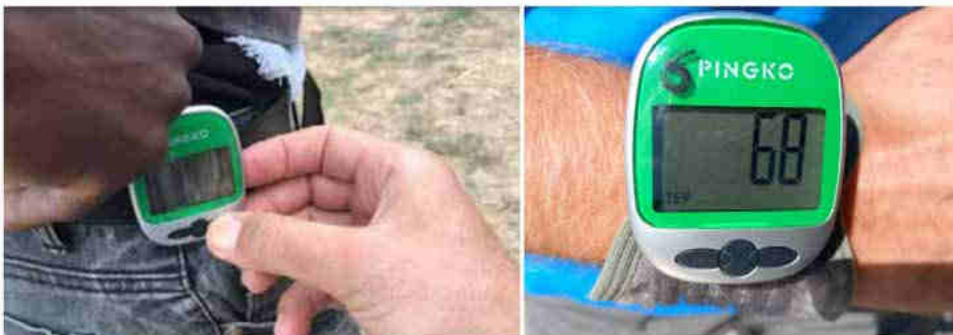
Figura 6. Detall del podòmetre a la cintura, per comptar passos, i al canell, per comptar moviment del braç, en un dels operaris.
