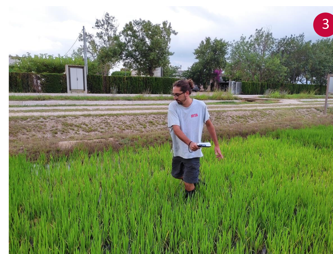
3 y 4. Valoración del índice de vigorosidad NDVI mediante el GreenSeeker®
